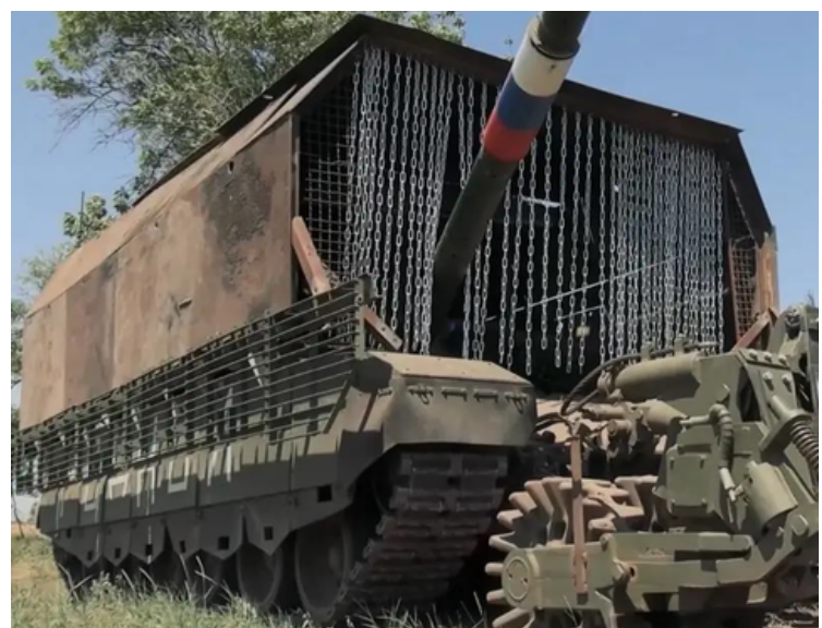
Imagen: Modificación improvisada de un T-80BVM en un “Tanque Tortuga”.
